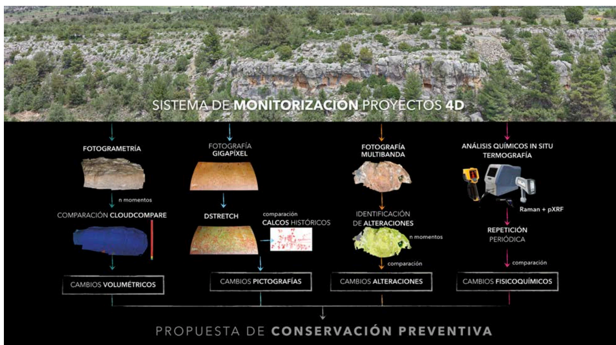
Figura 11. Esquema conceptual del sistema de monitorización desarrollado y aplicado en el marco de los proyectos 4D · arte rupestre.
